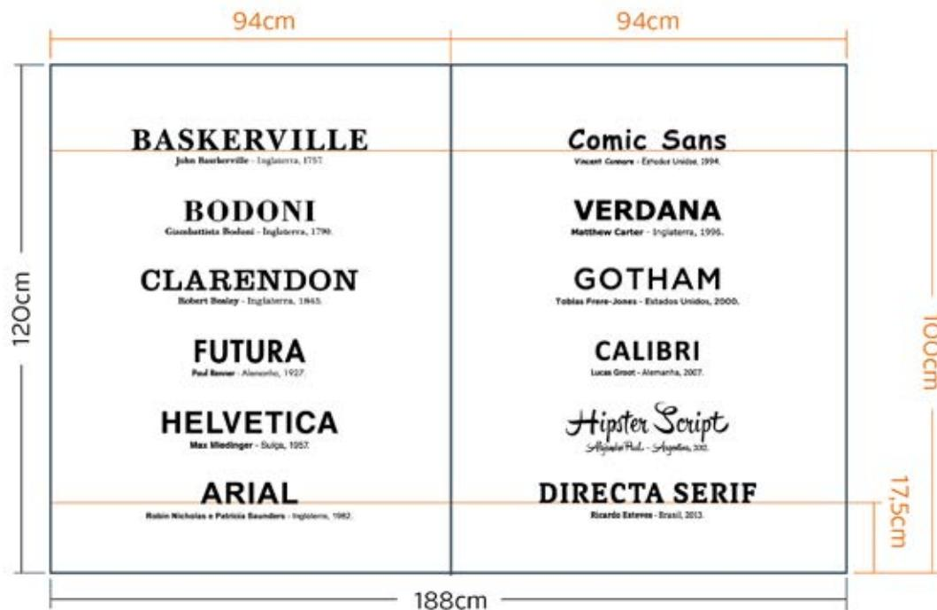
Figura 81 – Detalhamento técnico do painel de famílias tipográficas – 2 chapas de acrílico transparente incolor de 10mm de espessura (94,0 x 120,0 cm) e textos centralizados na chapa aplicados em vinil de recorte.
