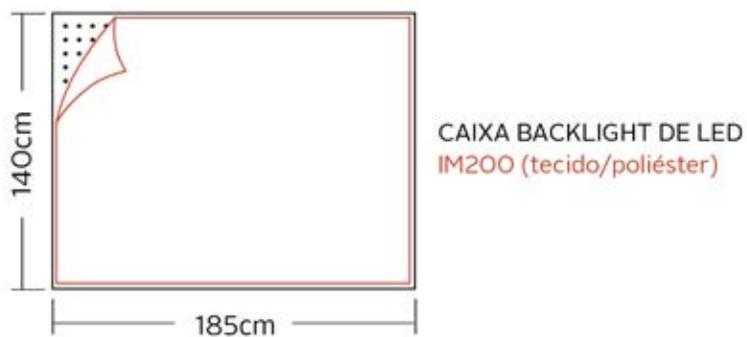
Figura 97 – Detalhamento da construção dos *backlights*.
