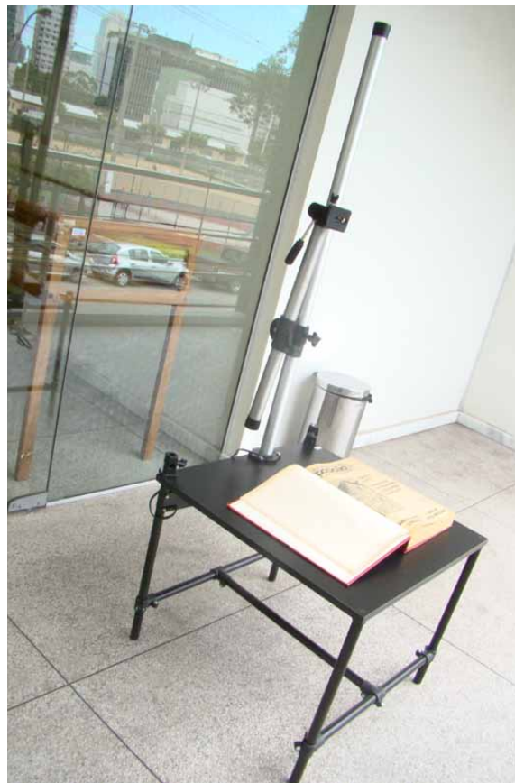
Figura 6: Imagem da mesa de fotografia para impressos utilizada no processo de registro fotográfico.
